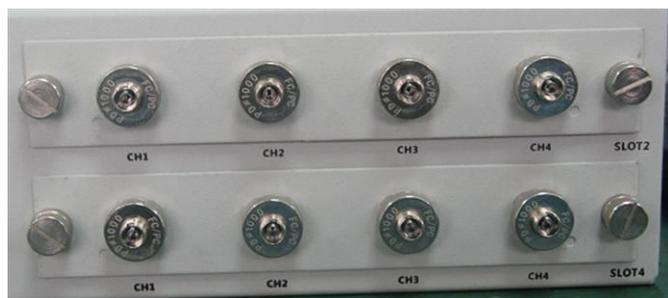
Front panel have 4 power measuring modules“SLOT1、 SLOTT2、 SLOTT3、 SLOTT4”,each module has 4 measuring channels“CH1、 CH2、 CH3、 CH4”.
